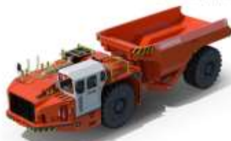
Camion à diesel 45 tonnes
