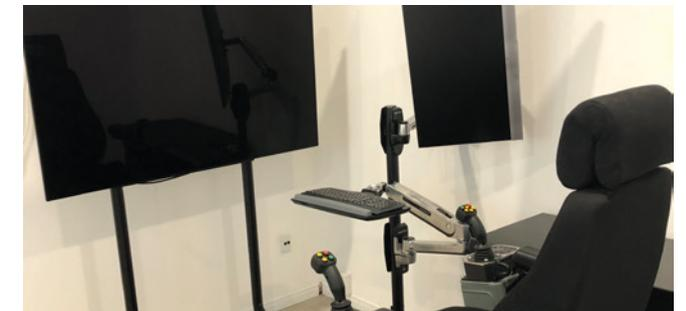
Cat command, nouvel équipement permettant le contrôle à distance d'une chargeuse navette à partir de la surface
