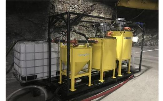
Traitement des matières en suspension dans l'eau de dénoyage à partir du système des Murs Sturda
