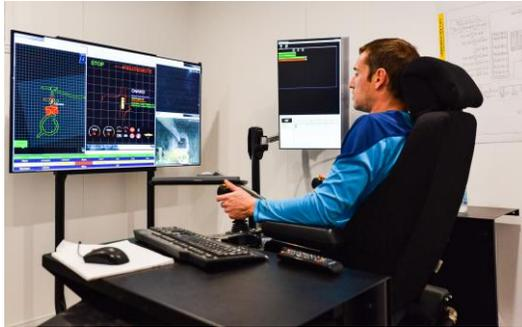
Opération télécommandée CAT Command pour les équipements d'excavation lors du développement
